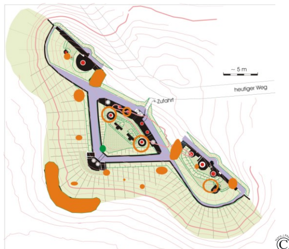
Abb. 1: Verteilung der magnetischen und elektromagnetischen Anomalien (orange/grün) im Bereich des Modell-Forts.
